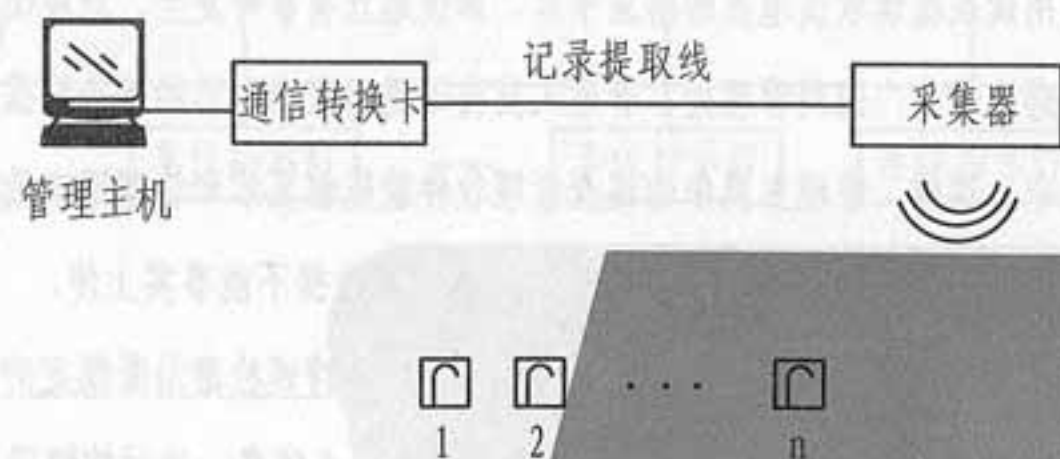
4.3 无线式电子巡查系统组成框图:
