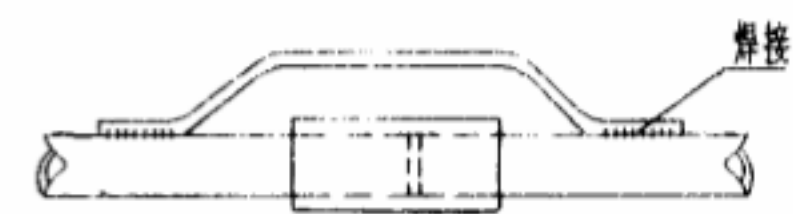
钢管套管连接跨接线做法图
