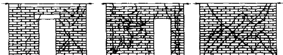
图 19.1.2 水平配筋砌体墙的破坏特征
