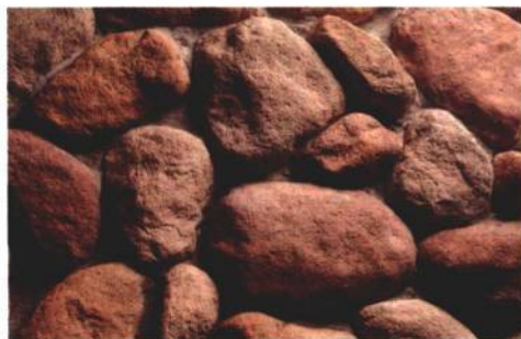
① 鹅卵石亦属于文化石的一种，粘贴时，水泥浆厚度要够，才能填满石缝。
