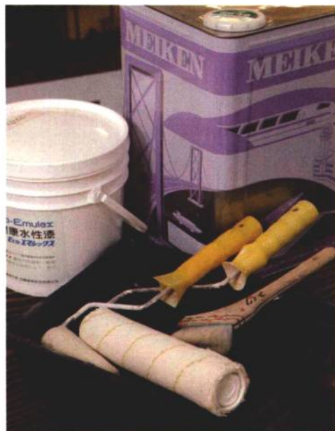
① 墙面施涂硅藻土的油漆盘、刷子、滚轮等工具。
