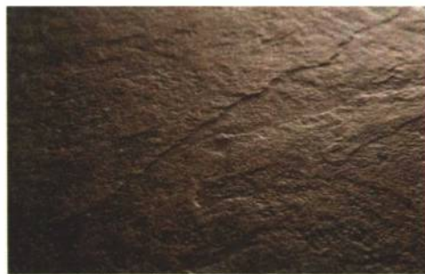
① 板岩砖表面如岩石般的凹凸不平的质感可以防滑。
