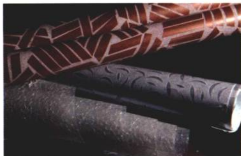
① 塑胶地砖的表层为透明薄膜（下），这层薄膜为主要耐磨层，越厚越抗磨。印刷花纹纸（上、中）则有仿木纹、石材等多种款式。
