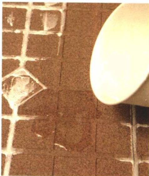
① 倒水于磁砖背面，可看磁砖的吸水率。湿气较重的卫浴空间，应慎选砖体。
