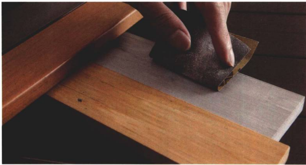
① 环保塑料木，即使经砂纸打磨，仍可看到木纹。
