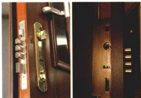
① (左) 多段式门锁，锁越厚，防盗性越强。 (右) 防爆锁采用6毫米的高抗力钢板来保护锁匣，断绝小偷强力撬门的机会。
