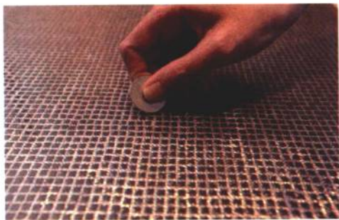
① 可使用硬币对方格交错而成的马赛克金属砖进行刮伤测试。除了立体釉彩金属砖以外，其他金属砖皆具耐刮磨的优点，可做地板。
