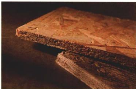
① 木屑间有少许缝隙，故使用久了也不易产生变形或破裂的问题。
