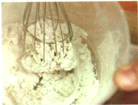
① 蛋白胶涂料只要加水调和，就可以调制上漆，无毒无味。替换壁材时也仅须将墙面喷湿软化后即可刮除。
