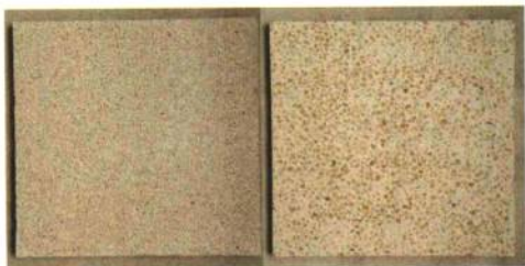
① (左) 抿石子建材表面可看到突出的小石头。(右) 磨石子建材表面光滑平整。
