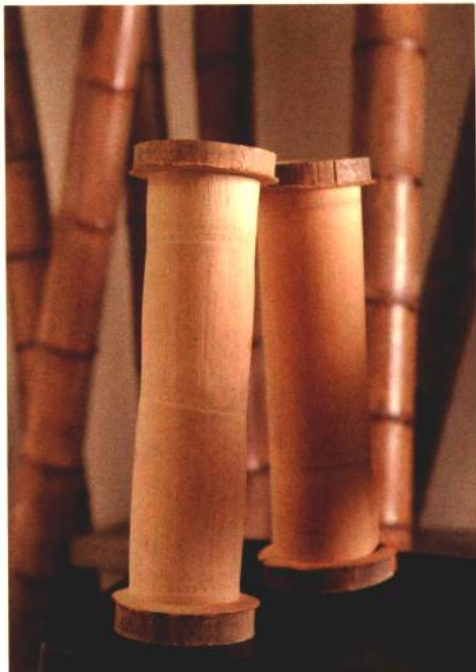
① 将竹节两端固定，再旋切竹身制作竹薄片，图中竹节为旋切后的最后样貌。
