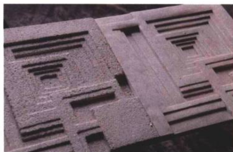
① 砂岩材质色彩比较：（左）为未加 Epoxy 的砂岩，表面较粗糙，颗粒也较明显，（右）则添加了 Epoxy，表面较光滑。
