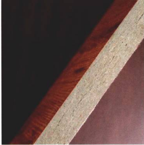
① 超耐磨地板（密集板材质）的剖面呈现一体成型。
