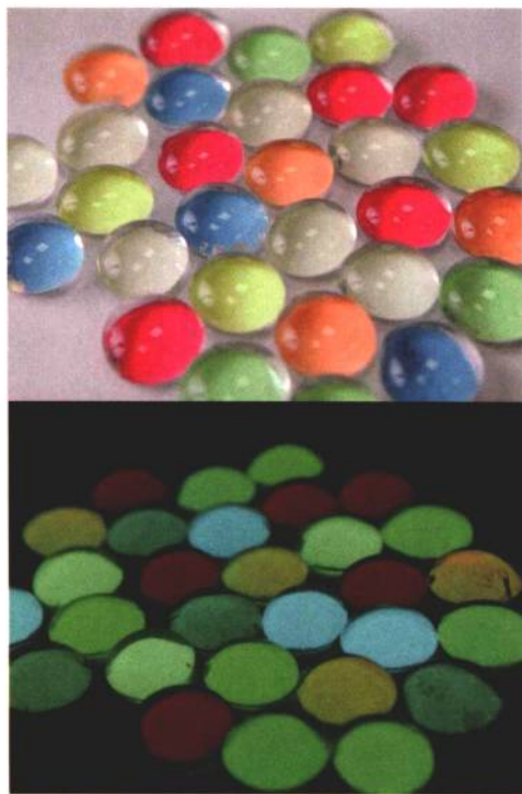
① 可在砖体背后粘贴色纸，再涂抹发光颜料，就能拥有多彩面貌。
