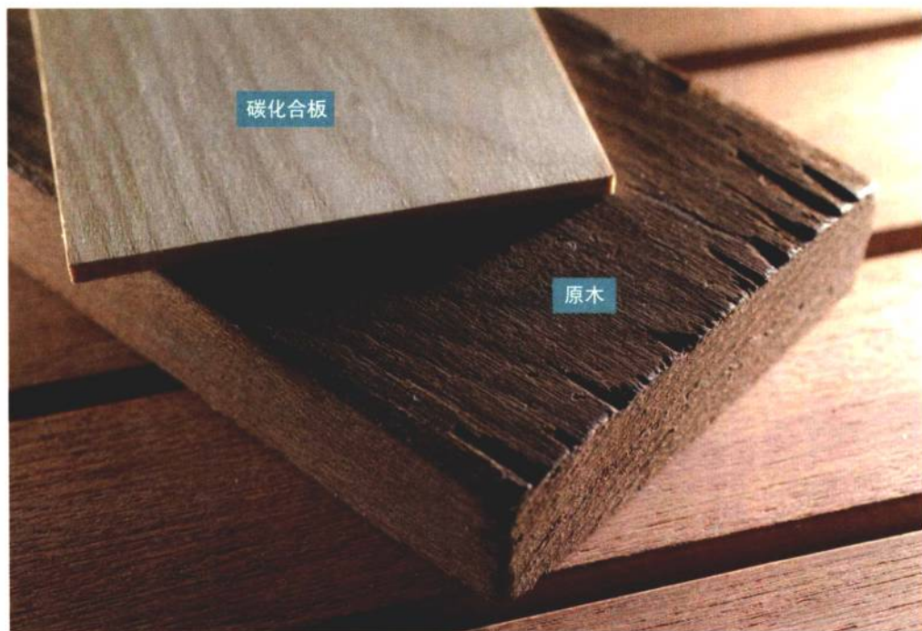
① 碳化过的木料（上方）颜色比原木浅，且硬度、抗湿度强，内部不含糖分及淀粉，无虫蛀问题。
