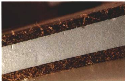
① 榻榻米中层夹有发泡隔热板。
