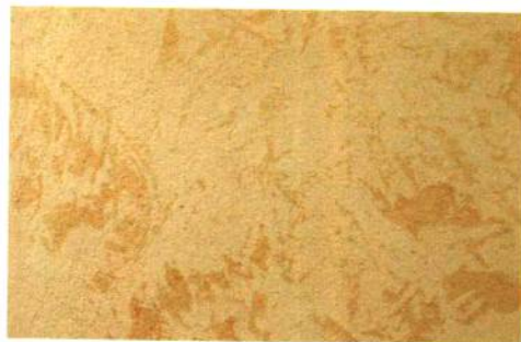
② 蛋白胶涂料，颗粒较粗，可在室内创造户外建筑的质感。
