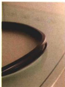
② 靠近面板及铁架中间的圆形黑色胶条，有固定容器及防止汤水跑到面板下的双重功能。
