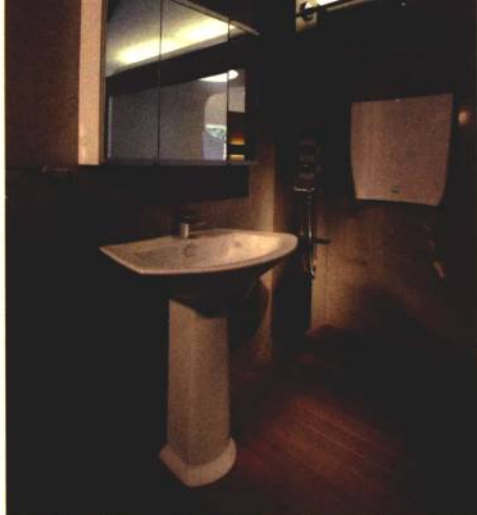
① 用支架固定独立盆于墙上，省略台面，最节省空间。下方可搭配脚架遮掩排水管。
