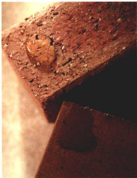
① 澳产盖模陶砖（上）和一般陶砖（下）各滴一滴清水测试吸水率，可看到盖模陶砖未吸水，维持水滴状，而一般陶砖则已渗透进去。
