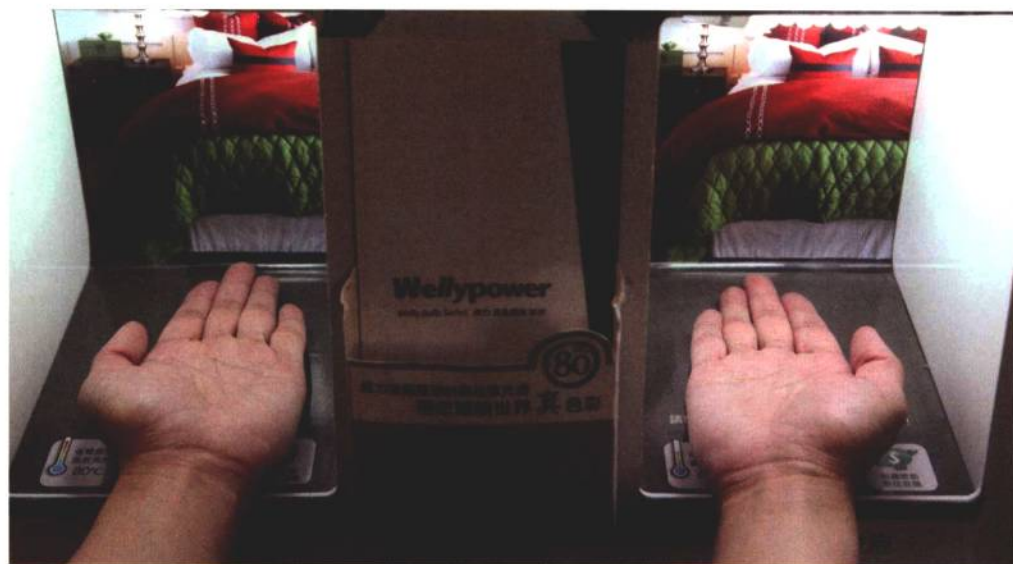
① CCFL 的液晶灯泡（右）与一般灯泡比较，可发现其色温不同。
