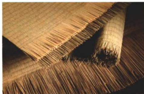
② 表层蔺草尾端较长者（下方处），代表取材自生长期完整的蔺草，草根饱满扎实，榻榻米才耐用。
