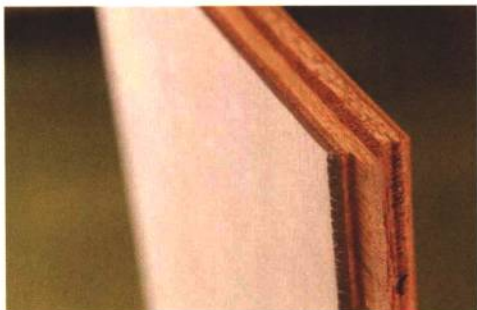
③ 竹地板的剖面照，将竹薄片粘贴在木质合板上，并在底层粘贴静音防潮泡垫。
