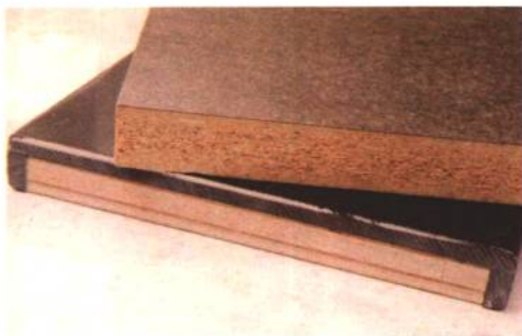
① 人造石台面内部包覆木芯板（下），美耐板台面则包覆塑合板（上），以木料为核心可增加台面韧性，但必须慎防液体渗入。
