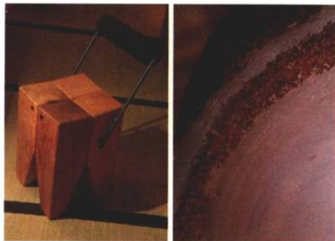
①（左）木料做成椅子，要留意木材材质，确认是否耐重不易损坏。（右）挑选木材时，外缘边材属新分化细胞，容易腐朽。
