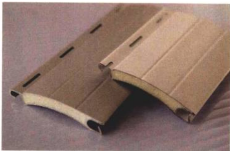
① 双层卷门中间加了一层聚氨酯发泡塑料，具节能效果。
