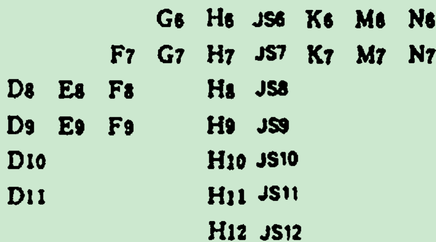
图 3.2-14 公称尺寸大于 500mm 至 3150mm 的孔的常用公差带 按照表 3.2-3、表 3.2-5 和表 3.2-6 所列的标准公
