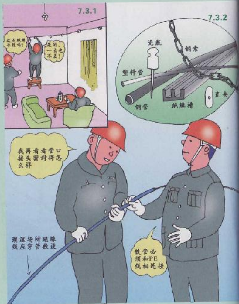
7.3.1 室内配线必须采用绝缘导线或电缆。
