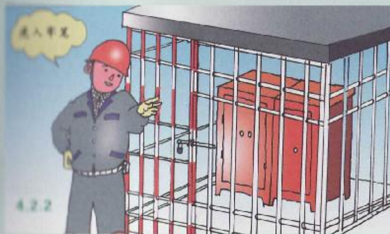
4.2.2 电气设备设置场所应能避免物体打击和机械损伤，否则应做防护处置。
