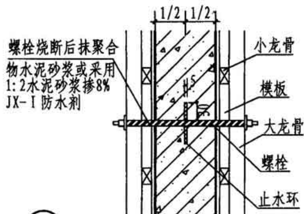
③ 模板穿螺栓防水构造
