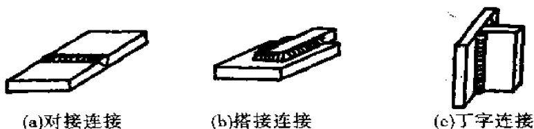
图 15.22 焊接的连接形式
