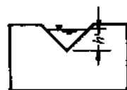
图 16-1 90^\circ 三角堰断面
