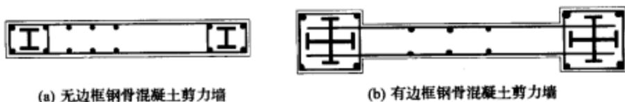
图 6-63 钢骨混凝土剪力墙的形式
