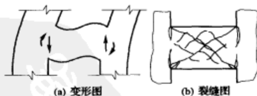
图 6-64 小跨高比连梁的变形和裂缝
