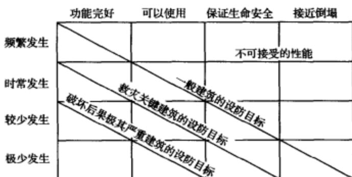
图 6-9 SEAOC 的结构抗震设防性能目标
