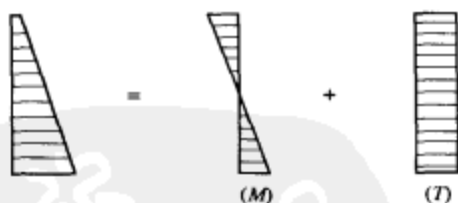
图 1-20 框支剪力墙转换梁跨中截面应力示意图
