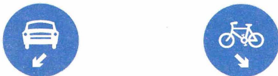
(a) 机动车行驶标志附加左侧行驶箭头 (b) 非机动车行驶标志附加右侧行驶箭头
