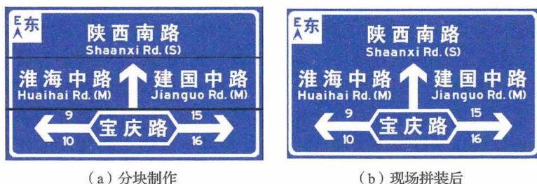
图 19 工厂分块制作现场拼装
