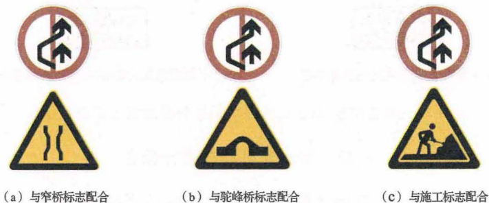
图 31 禁止超车标志与警告标志配合使用的设置
