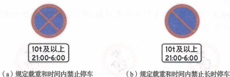
图 32 禁止停车、禁止长时停车标志与辅助标志配合使用
