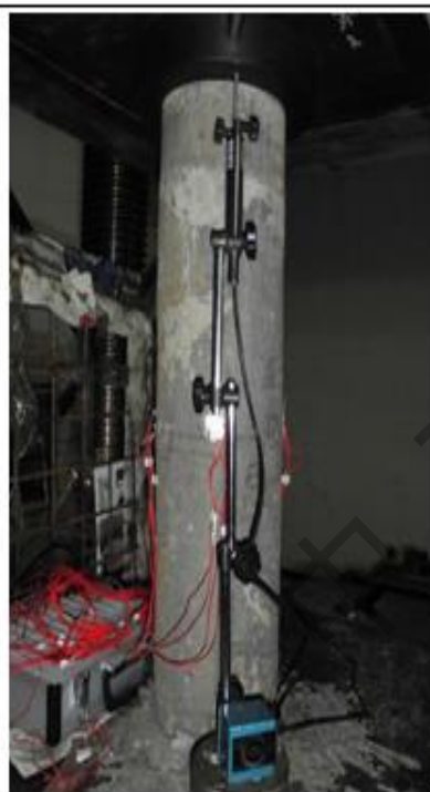
C100 钢管混凝土试验图
