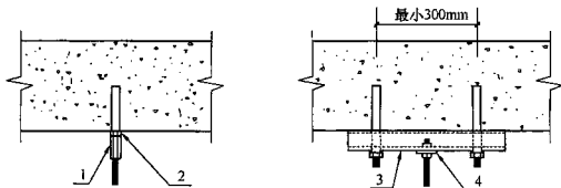
图 7 吊杆根部构造示意图（钢筋混凝土结构）
