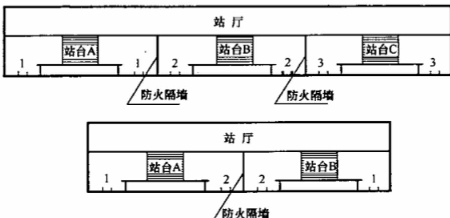
3 多线点式换乘车站，是指二线站台之间的“+”、“T”、“L”型换乘，三线站台之间“△”、“++”、“口”、“Y”、“H”等形式换乘，以及站厅之间的通道换乘。它们之间的换乘梯和换乘通道均应设防火隔断，仅在通道（梯）两端洞口处设防火卷帘，分线控制。换乘通道或换乘梯不能作为火灾工况下的安全疏散口，发生火灾时由火灾车站侧落下防火卷帘。
