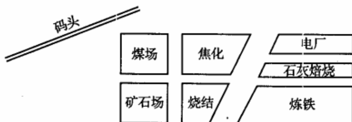
图1 某钢铁总厂有关设施相互位置示意图
