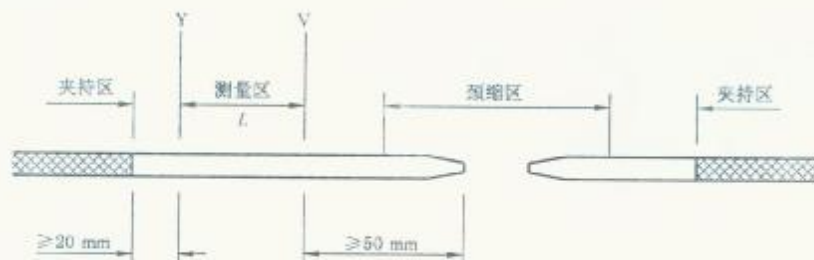
图 A.1 断裂后的测量
