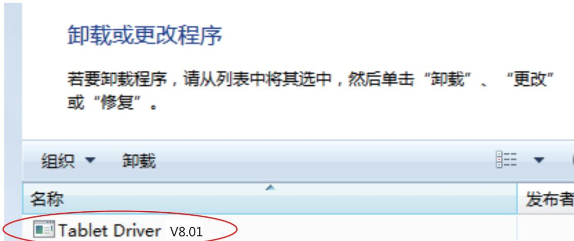
(2) 安装驱动程序时，请按照安装指示画面步骤按下 Enter 键，在完成软件安装后，请将 USB 线接到电脑 USB 端口上后重新启动计算机。待电脑完全重新启动后您会在屏幕的右下角看到一个手绘板小图标 (
