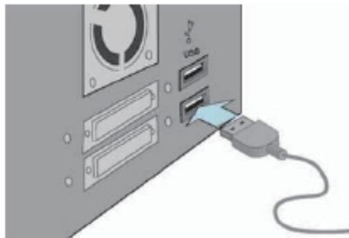
**※ 请务必在驱动程式安装完成后，再将手绘板连接于电脑上，以避免系统识别硬体的过程中产生驱动程式安装延迟或错误。**
