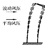
图 3.31 风压下建筑物的变形示意图
