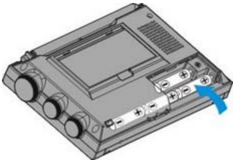
正确安装充电电池
