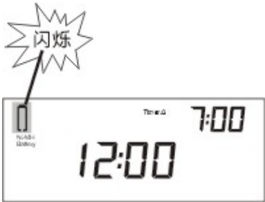
机内没有安装电池，使用稳压电源供电时的显示
