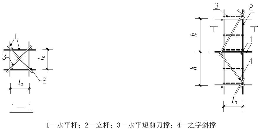
图10 4条立杆围成的格构柱
