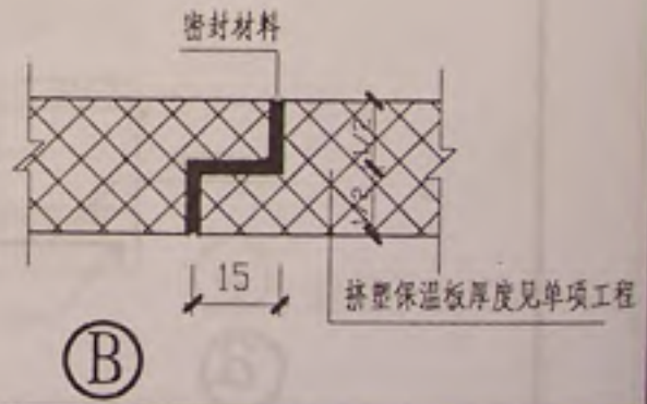
倒置式保温板布置
