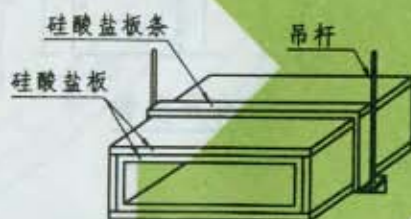
硅酸盐板风管吊装
