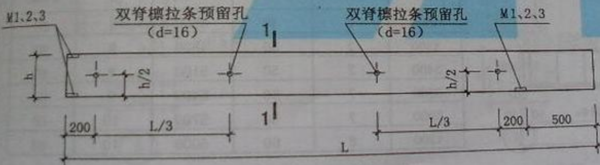
YRLTYXX-XX 檩条立面 (檩条与支座的连接采用焊接)
