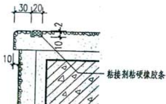
⑥ 预制水磨石踏步防滑条
