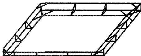
偏沟式单算雨水口支座配筋大样
