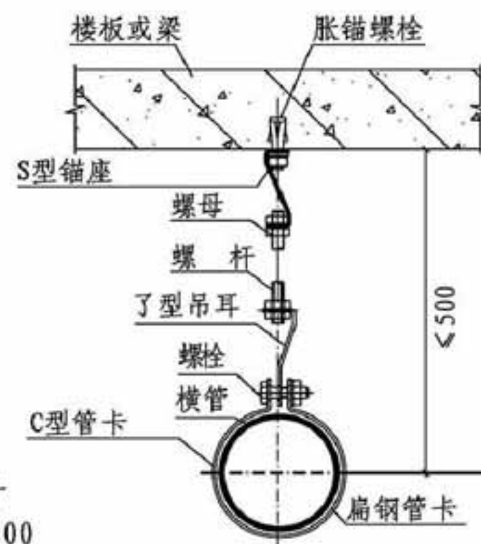
排水铸铁管系安装示意图
