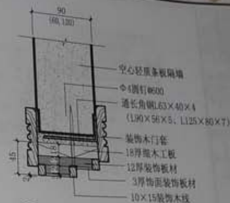
3 门框与空心轻质条板隔墙过梁板连接 用于门洞宽1800~2400
