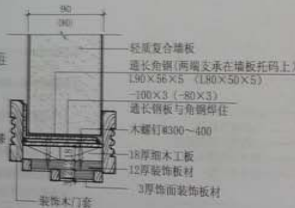
4 门框与轻质复合墙板过梁板连接
