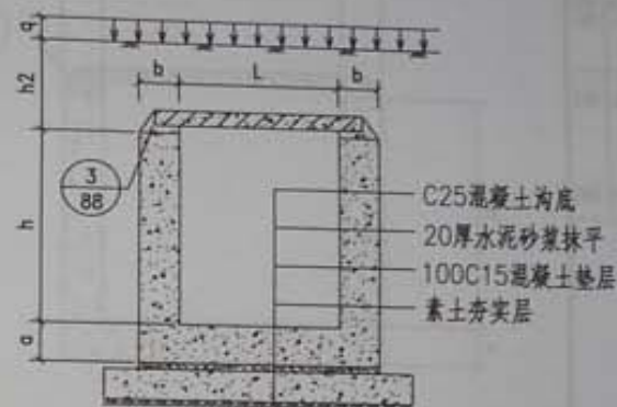
素混凝土沟尺寸示意图
