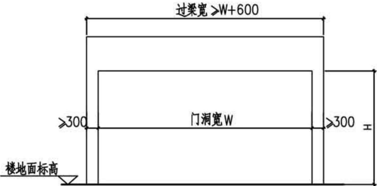
钢筋混凝土门框示意图
