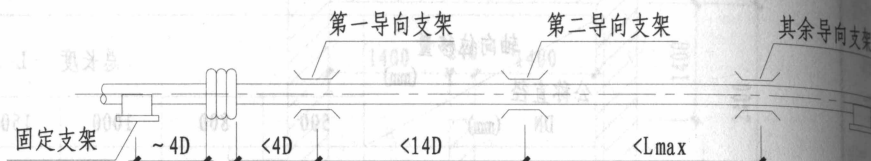
轴向式波纹伸缩节固定支架和导向管架的分布示意图
