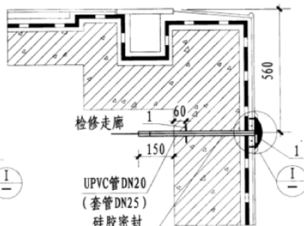
水下灯具安装图（有检修走廊）
