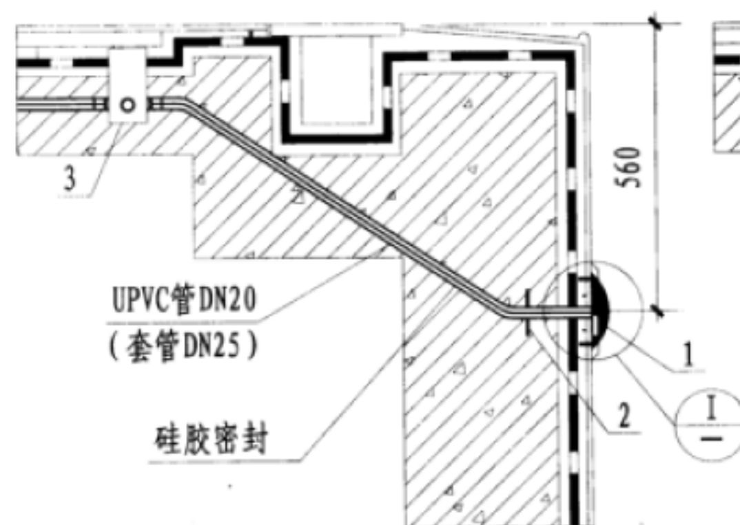
水下灯具安装图（无检修走廊）
