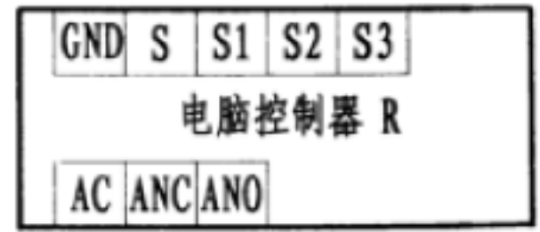
电极式加湿器电脑控制器接线端子示意图
