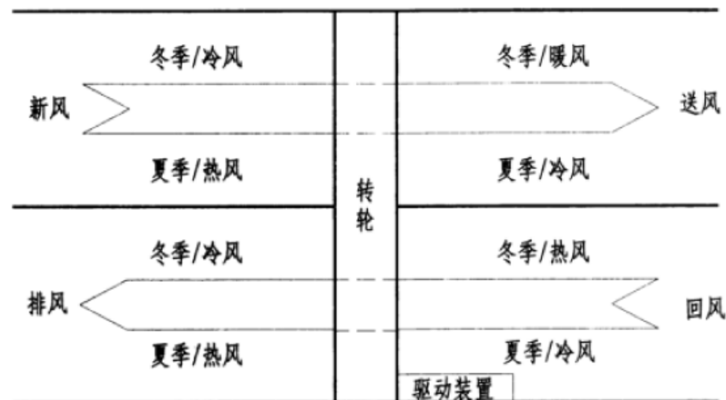
转轮式热回收器原理示意图
