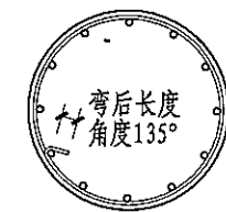
螺旋箍筋端部构造
