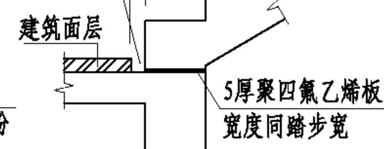
(2) 设聚四氟乙烯垫板 (梯段浇筑时应在垫板上铺塑料薄膜)
