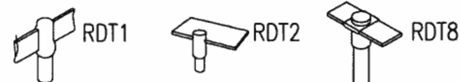
RDT系列扁带与电接地体(棒)防腐熔焊
