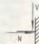
雨篷主梁对主体结构边缘产生的内力N和V
