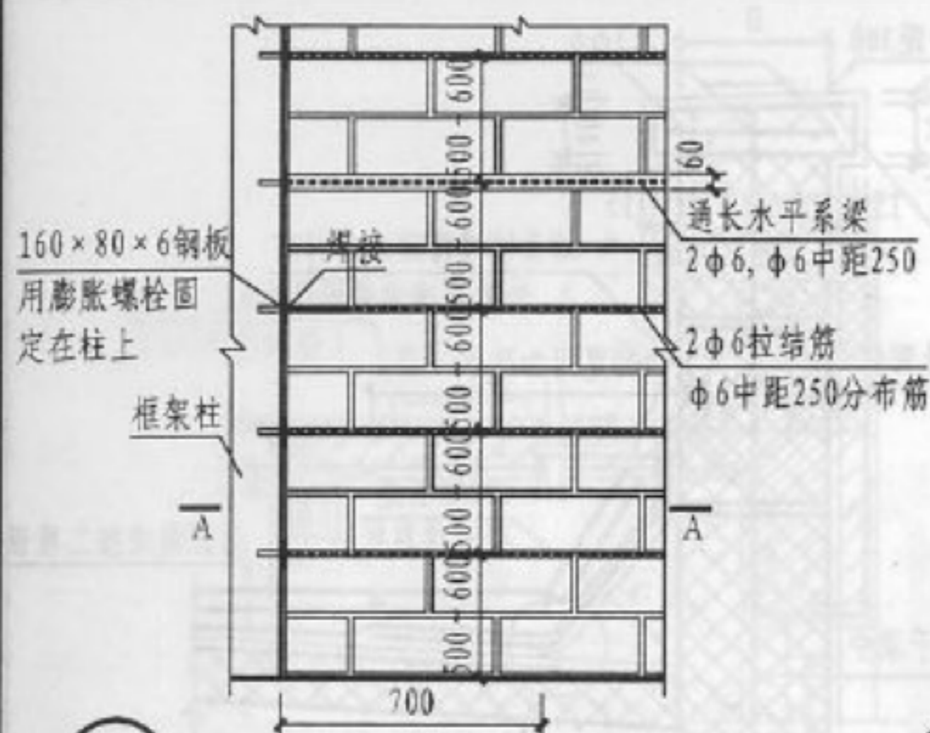
① 加气混凝土填充墙与框架柱拉结
