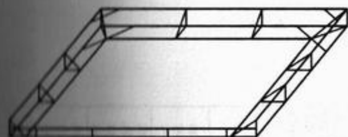
偏沟式单算雨水口圈配筋大样
