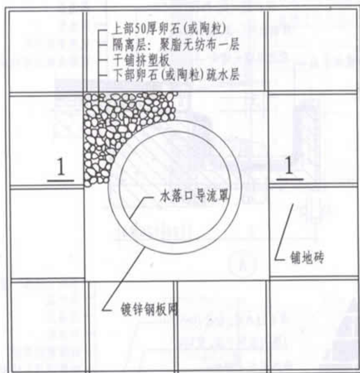
① 屋面直排式水落口平面
