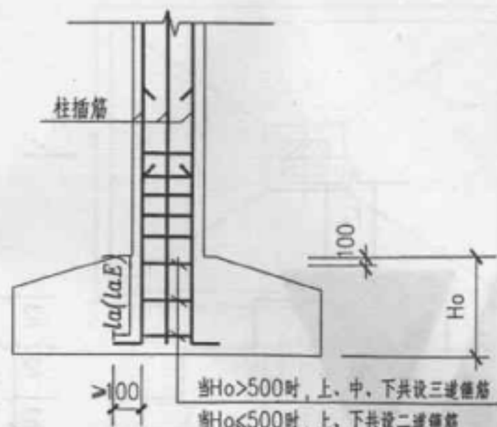
现浇柱基础中柱插筋构造示意
