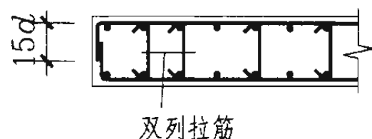
无暗柱时剪力墙 水平钢筋锚固 (二)
