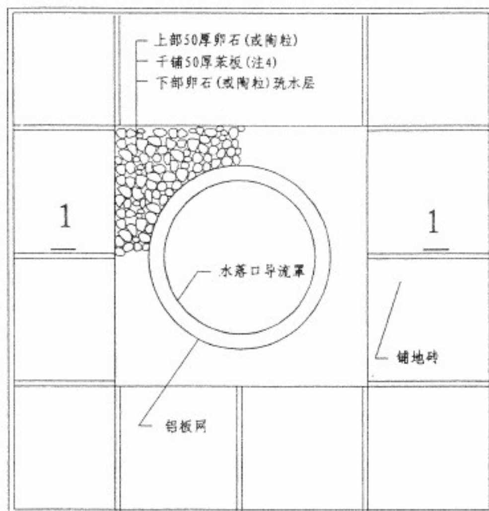
1 倒置式屋面直式水落口(87型)平面
