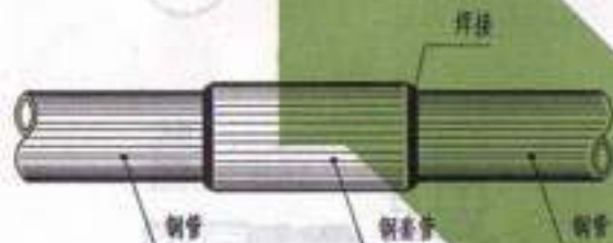
钢管-钢套管连接
