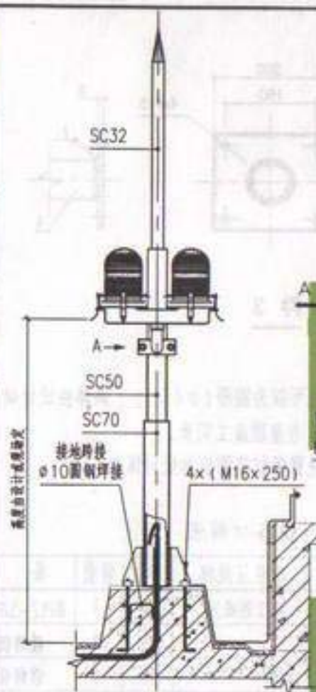
针杆型支柱屋顶安装示意图
