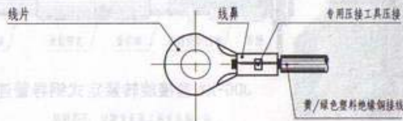
OT型接线端子接线示意图
